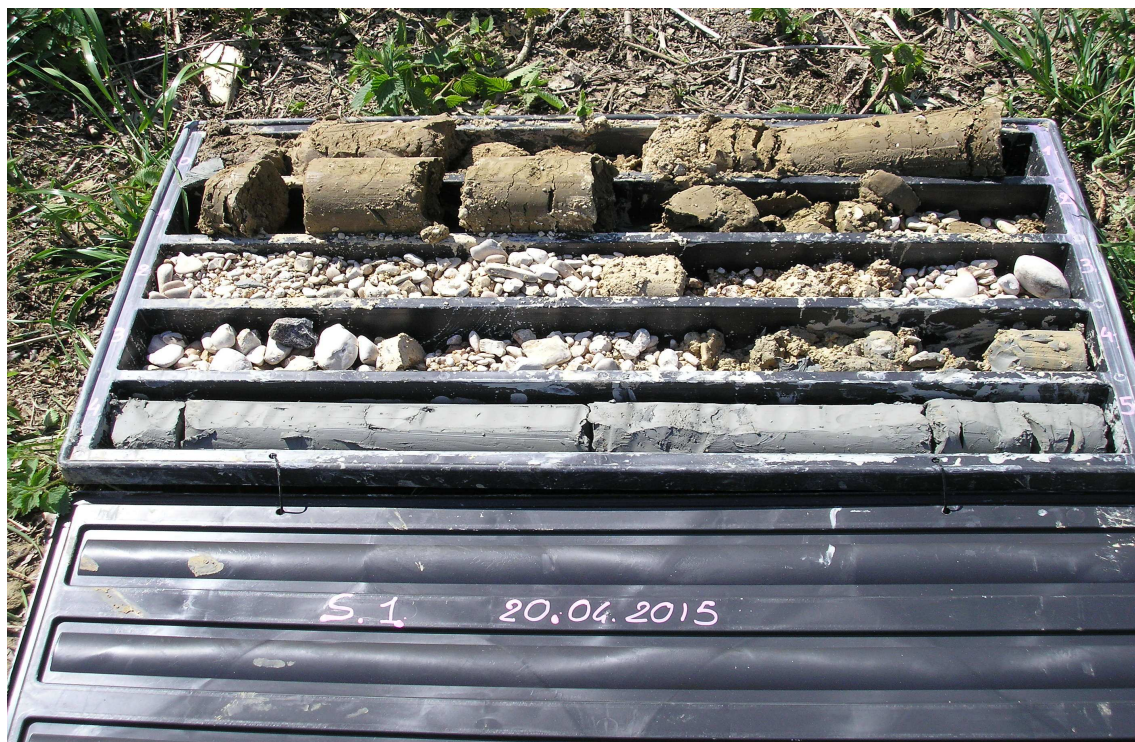
Foto n. 6 – Sondaggio n. 1 – carotaggio
