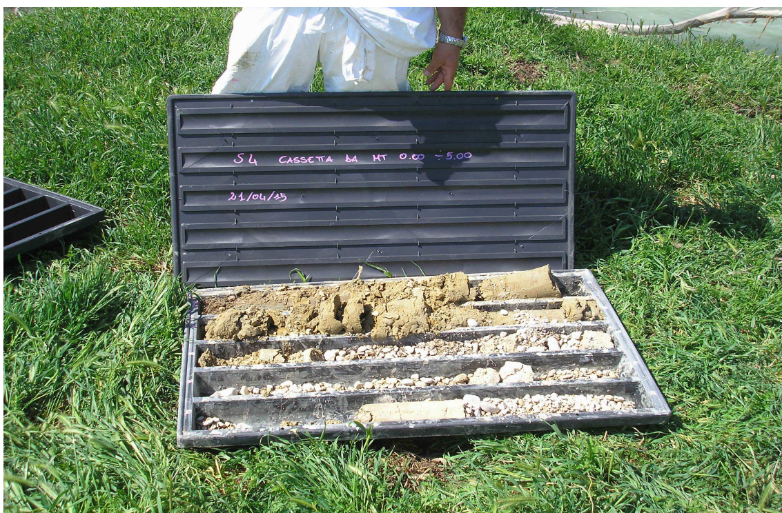
Foto n. 13 – Sondaggio n. 4 carotaggio
