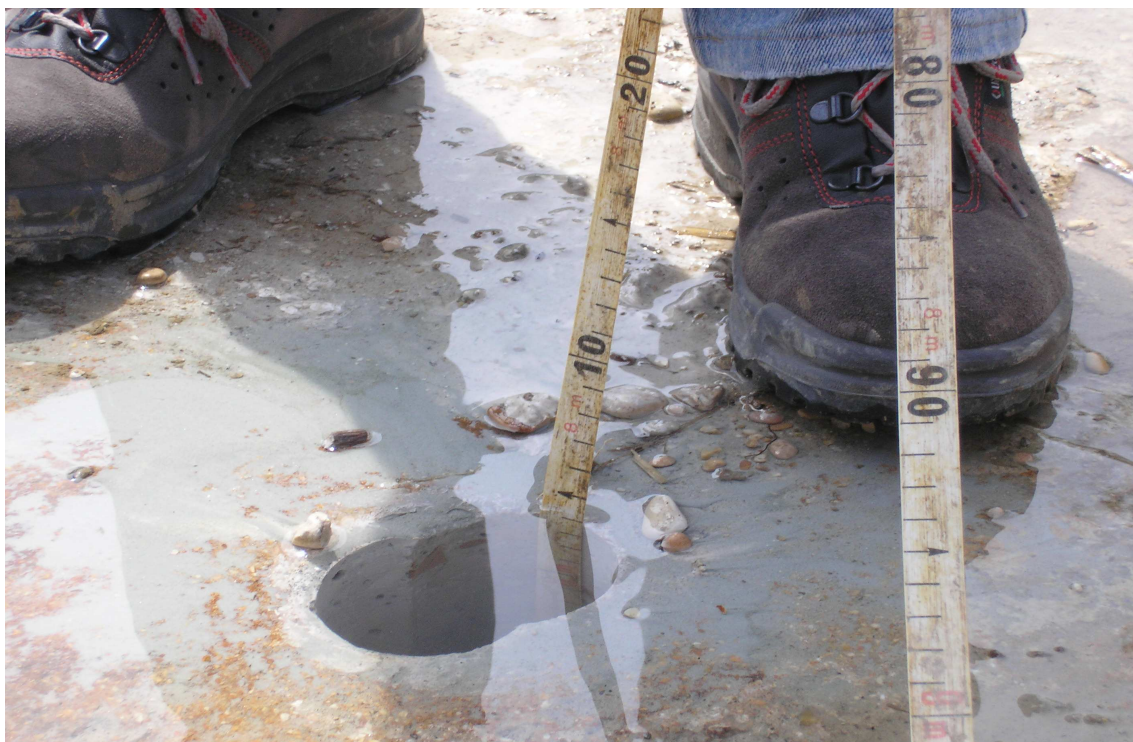
Foto n. 4 – profondità perforazione struttura di fondazione briglia
