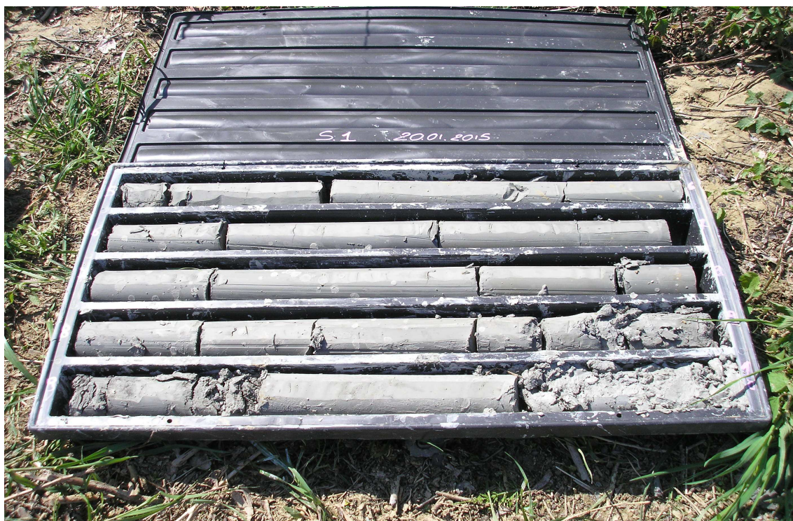
Foto n. 7 – Sondaggio n. 1 – carotaggio
