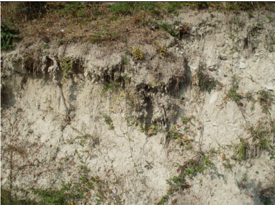
Foto 6 – Settembre 2009. Substrato alterato e copertura eluvio - colluviale a valle del dissesto del dissesto, presso la rottura di pendenza a valle della SP 118 dir.
