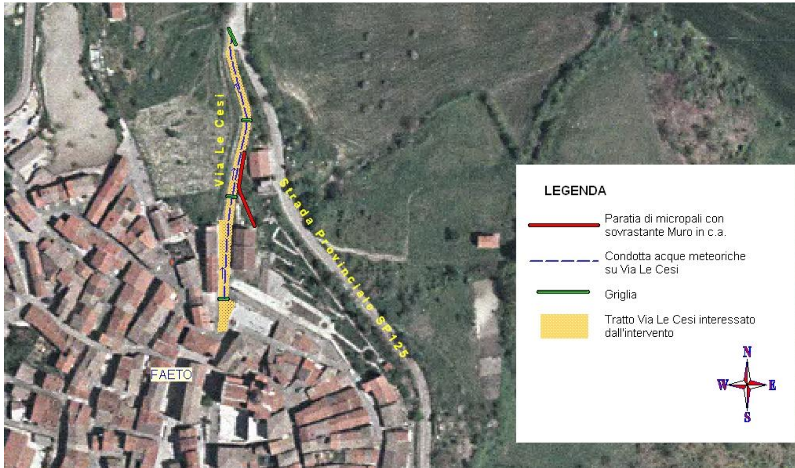
Fig.2 Ortofoto della zona Giarosetta – Via Le Cesi, nella periferia nord-orientale di Faeto (FG), con ubicazione degli interventi in progetto riportati nella Tavola A3 del progetto esecutivo “Lavori di Risanamento Area Giarosetta in agro del Comune di Faeto – Progetto Stralcio” - (Compagnia Generale riprese aeree S.p.A. Parma).
