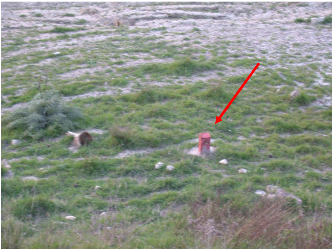
Foto 11: foro di sondaggio, attrezzato con tubo inclinometrico, posizionato nel pendio sottostante il piazzale dell'ospedale (foto di aprile 2003)
